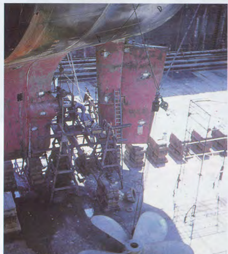
L'entretien de l'arbre d'hélice permet de voir le gouvernail.
