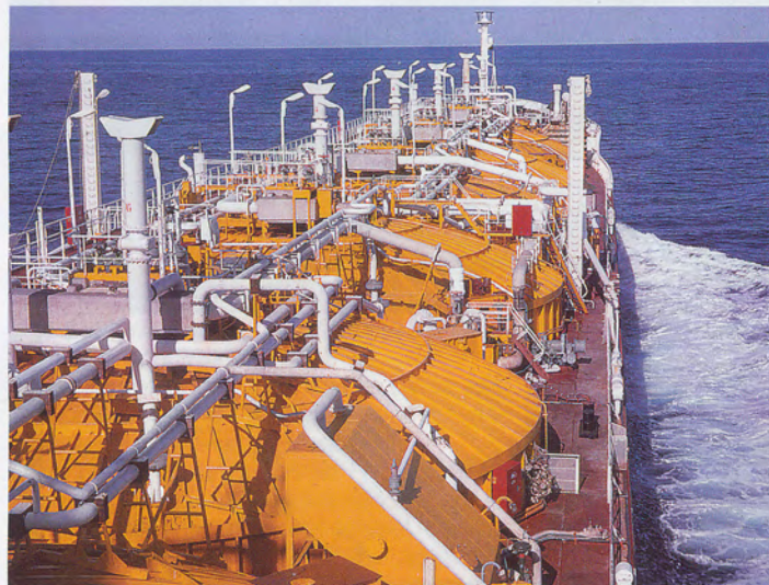
Alignement des cheminées de dégazage.
